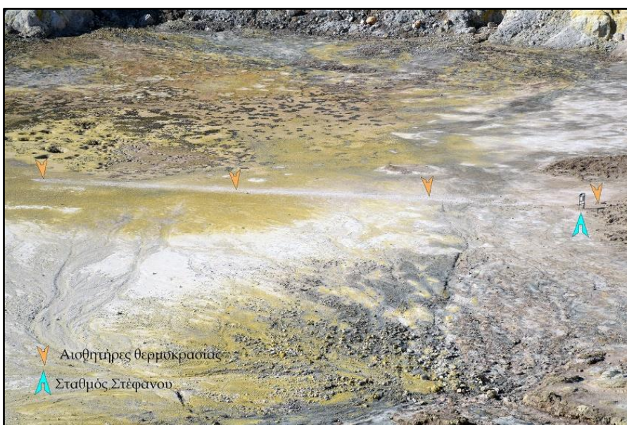
Εικόνα 4: Διάταξη αισθητήρων θερμοκρασίας στο σταθμό Στέφανου Νισύρου
